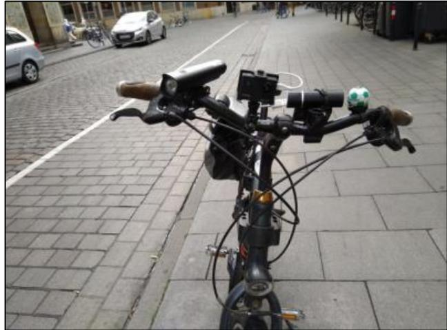
Abbildung 8: Fahrrad mit Dash-Cam, zusätzlicher Beleuchtung, Akku-Reserven
